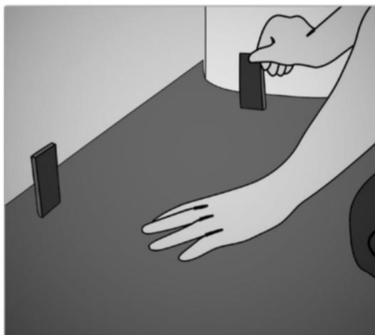
3. Comece a instalar as régua paralelamente à parede de maior largura da sala. Coloque a 1ª régua com o lado macho voltado para a parede. Em seguida, coloque a 2ª.
