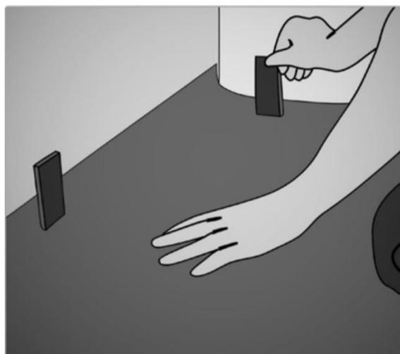
3. Comece a instalar as régulas paralelamente à parede de maior largura da sala. Coloque a 1ª régua com o lado macho voltado para a parede. Em seguida, coloque a 2ª.
